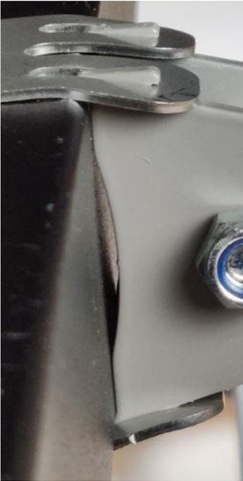
Entfernen Sie die 4 Innensechskant-Stellschrauben aus der quadratischen Metallplatte. Drücken Sie die zwei Seitenplatten (Hakenanker) gegen den Rahmen, sodass an der anderen Seite ein Platz zwischen dem Rahmen und der Klemme entsteht. Schieben Sie hier die quadratische Metallplatte dazwischen, bis sie schön in der Klemme zentriert ist.
