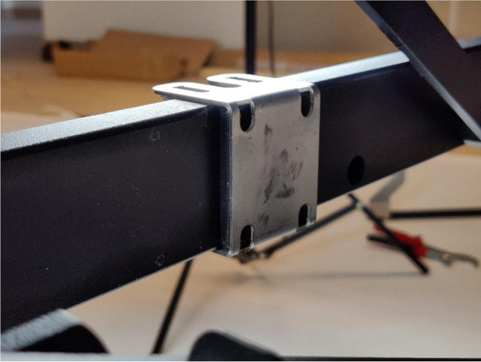
Ziehen Sie die Schrauben an, damit die Klemme auf dem Rahmen befestigt wird.
