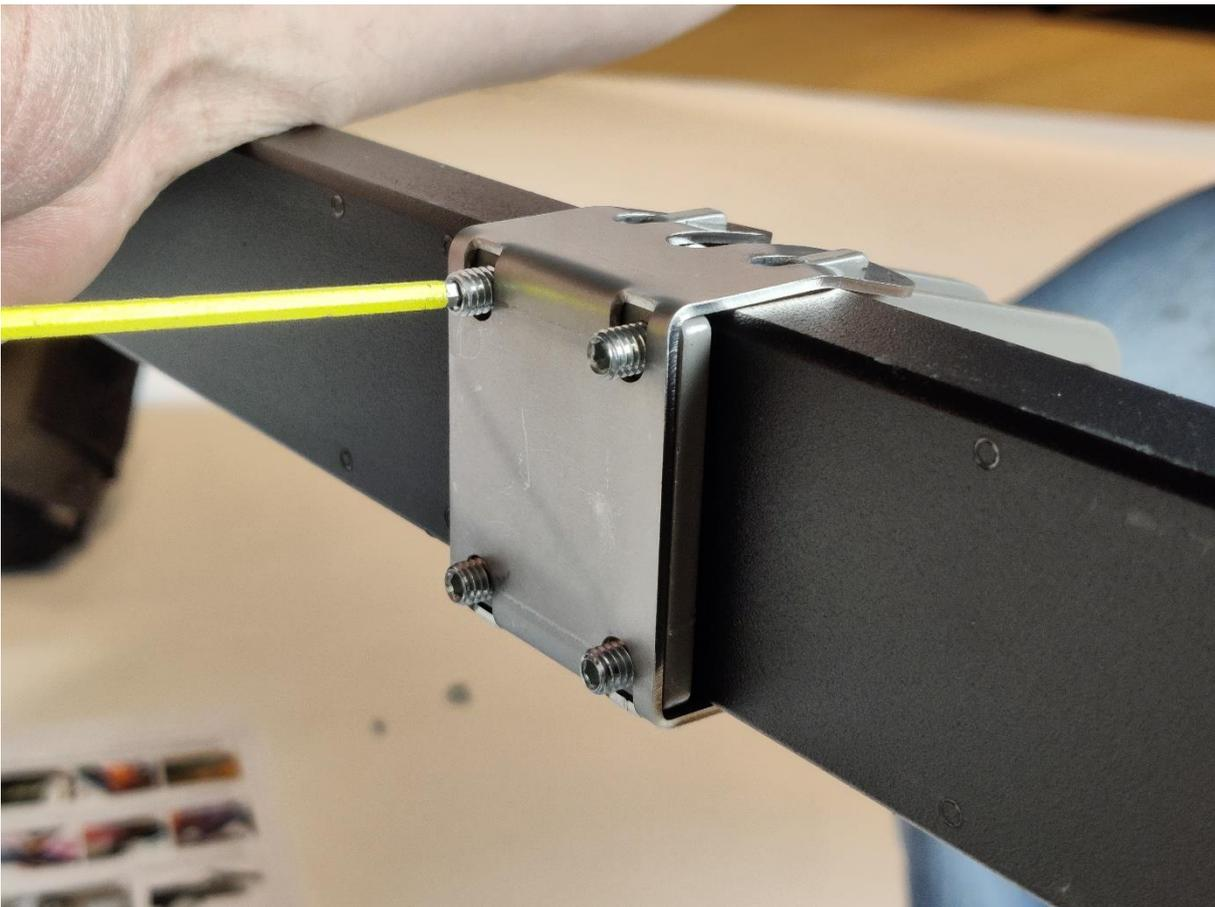
Platzieren Sie den Halterarm zwischen den 2 Seitenplatten und befestigen Sie diese mit den 2 Schrauben und Muttern.
