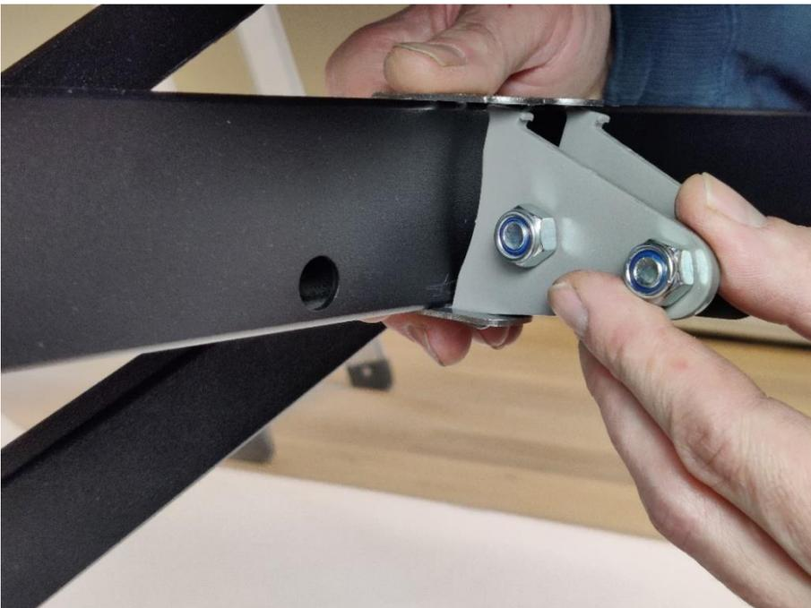
Drücken Sie den Edelstahl-Befestigungsbügel zu, sodass die Seitenplatten in den Furchen des Befestigungsbügel einhaken.
