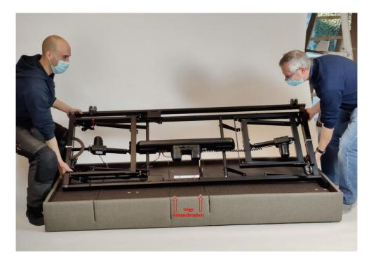
Entfernen Sie alle roten Kabelbinder, einschließlich derjenigen, mit denen das Netzkabel und die Fernbedienung befestigt sind.
