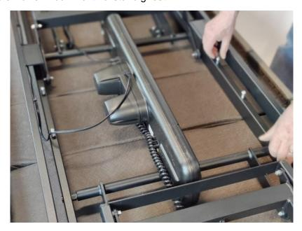
Schrauben Sie jetzt auch alle zuvor gelockerten Bolzen etwas fest.
