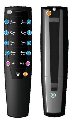
Wenn die Status-LED und die Hintergrundbeleuchtung der Fernbedienung blinken, ist die Fernbedienung noch nicht auf den Motor abgestimmt.
