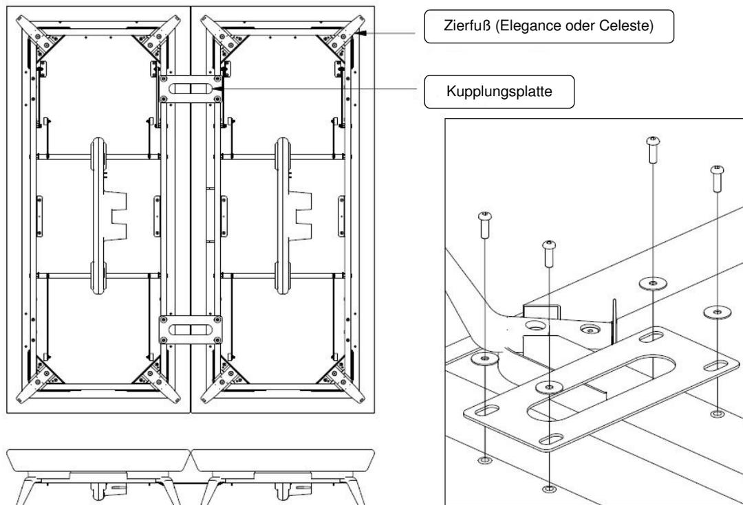
**Schritt 6a: Montage Kopfteilbeschlag – Entfernung der Abdeckplatten**
