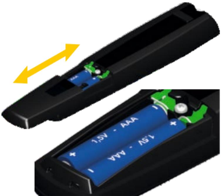
Nachdem die Batterien eingelegt und der Batteriefachdeckel wieder verschlossen wurde ist die Fernbedienung betriebsbereit.
